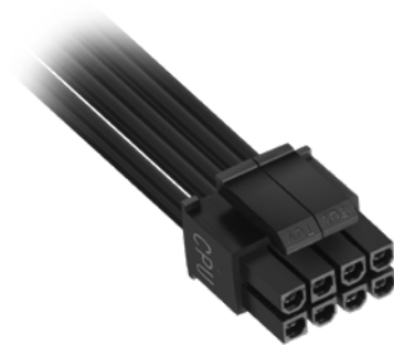
1x 4 + 4-контактный разъем питания процессора
