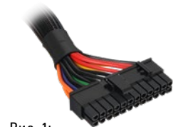
Рис. 1: 20 + 4-контактный разъем для материнской платы
