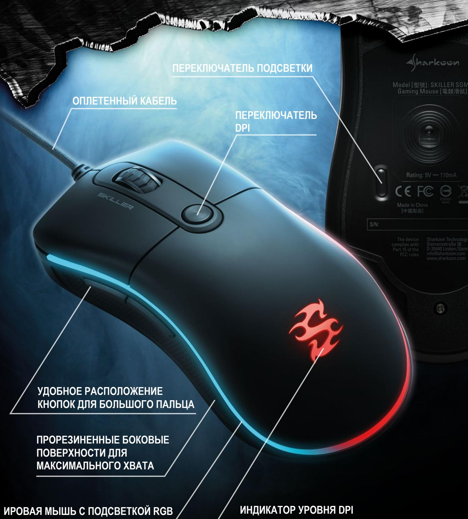
Когда выбран DPI шаг, подсветка меняет цвет на несколько секунд и кратковременно мигает, чтобы указать выбор. Подсветка может быть вкл/выкл при нажатии кнопки на нижней поверхности SKILLER SGM2. Кроме того, кнопка вкл/выкл также может быть использована при выборе одного из четырех режима подсветки, без использования ПО.
